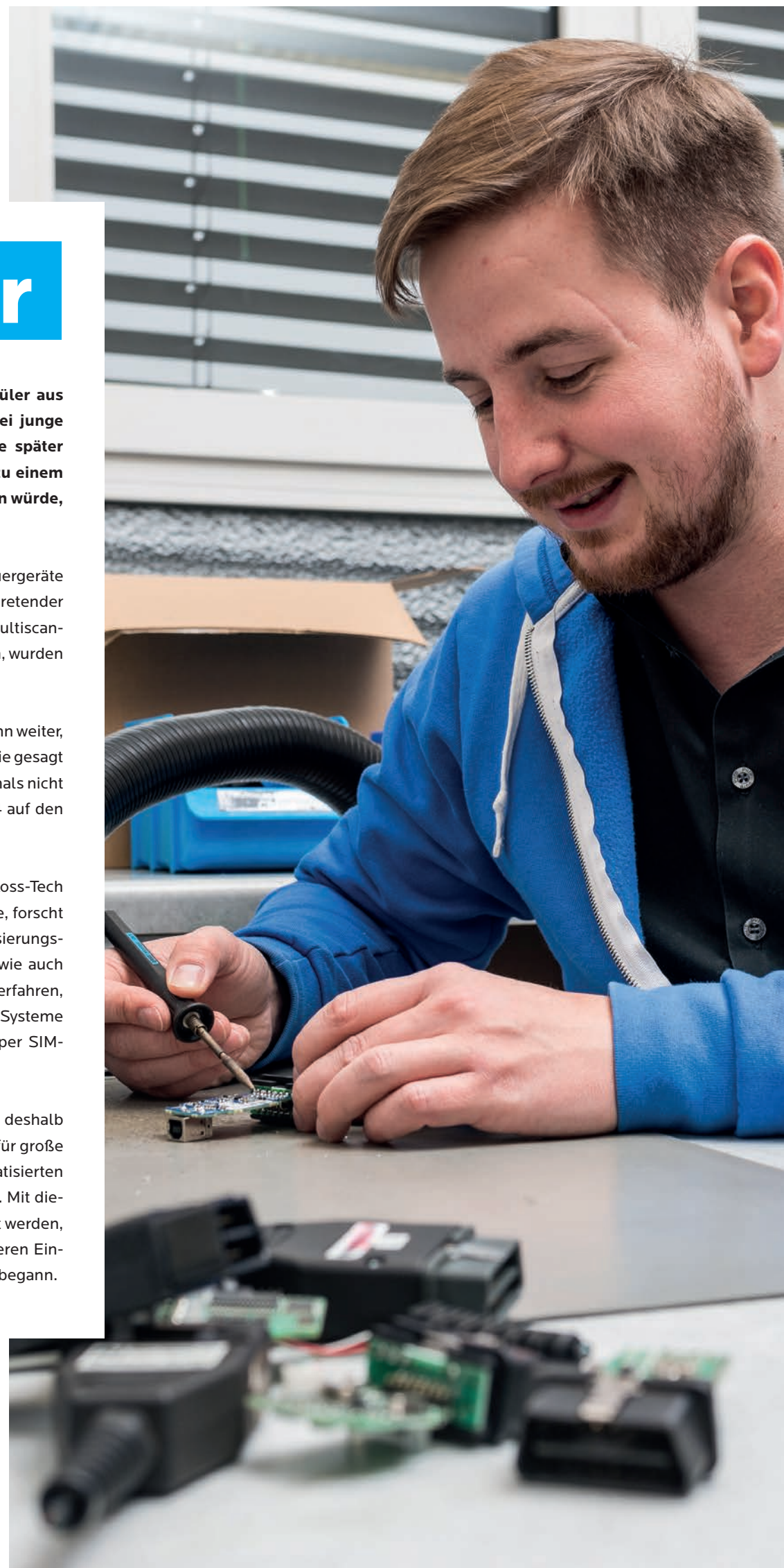
Stephan Bökelmann bei der Fertigung eines Diagnoseadapters.
